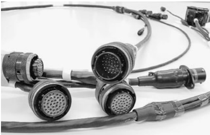
マシンの電気信号を伝えるワイヤーハーネス
